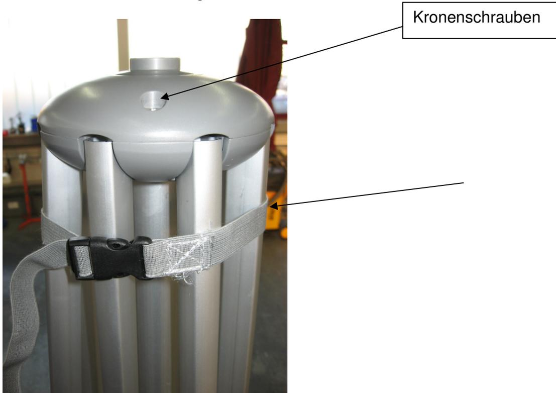
Um den Kronenkranz abnehmen zu können, müssen die Kronenschrauben (eine um die andere) entfernt werden. Streben oder Spannhebel können heraus genommen werden. Neue Streben oder Spannhebel danach wieder einhängen.
